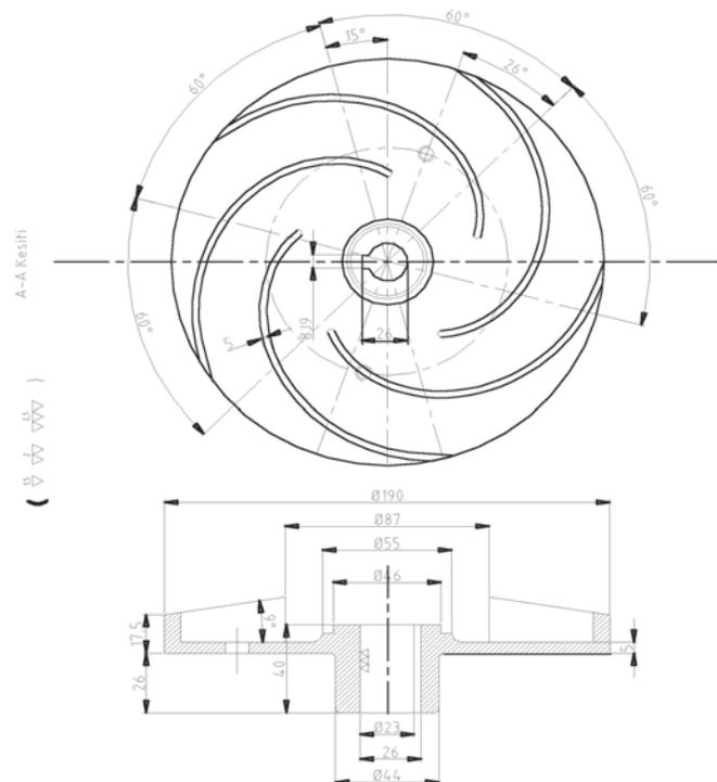
**Fig. 4** Open impeller
