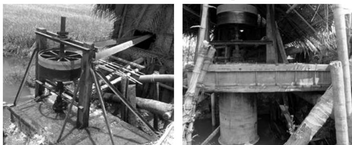
**Fig. 3a** The impeller; **3b** Butterfly valve
