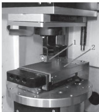
**Fig. 3** UMT-2 tribometer
