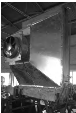
Fig. 1 Fan using in unit cooling
