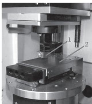
**Fig. 3** UMT-2 tribometer
