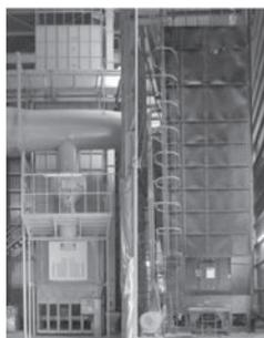
Fig. 6 Husk furnace paddy dryer
